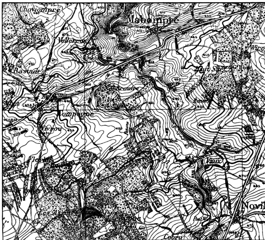
Fig. 1. — Mouvement d'une courbe de niveau. Accentuation par un gros trait de la courbe de 450 m.
